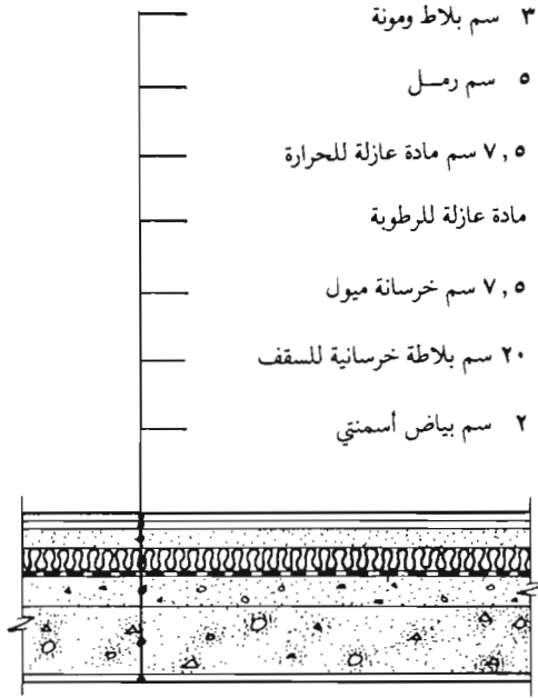
شكل ١٠ . بلاطة سقف خرسانية معزولة حراريًا.
