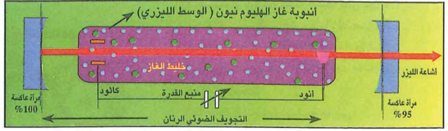
● شكل (٣) مكونات جهاز ليزر الهليوم - نيون
