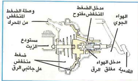
● شكل (٥ ب) الكابح المساعد في الوضع العادي (إنخفاض الضغط على جانبي الرق).
