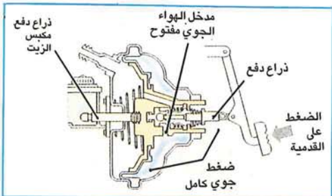
● شكل (٥ ج) الكابح المساعد عند الضغط على القدمية لإيقاف السيارة .
