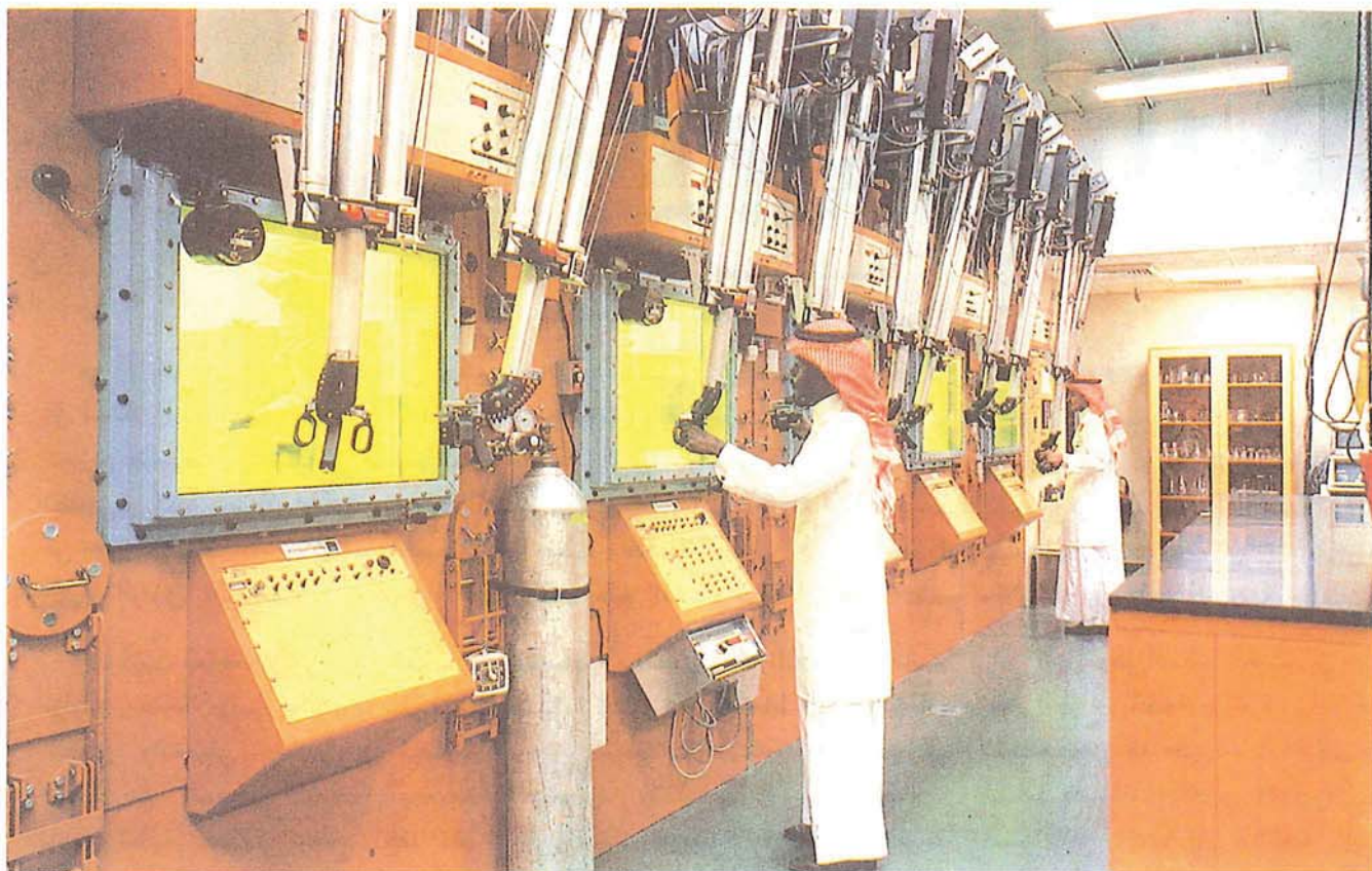
الخلايا الحارة : يتم داخلها استخلاص وتنقية المواد المشعة بواسطة الأذرع المثيلة
