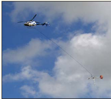
■ شكل (٥) المسح المغناطيسي الجوي باستخدام طائرة هليكوبتر.
