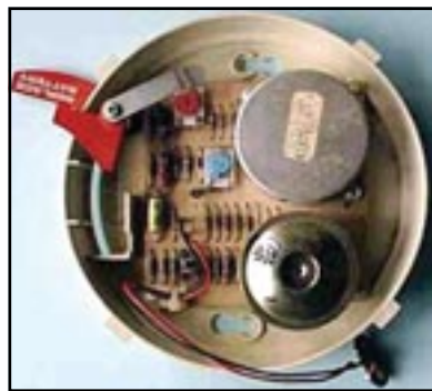
● شكل (٥) مكونات كاشف الحريق الأيوني
