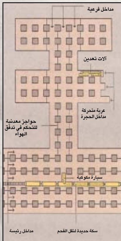
● شكل (٤) استخراج الفحم بطريقة الحجرة والأعمدة.
